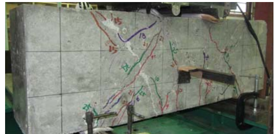
写真-3 補修載荷後供試体状況
