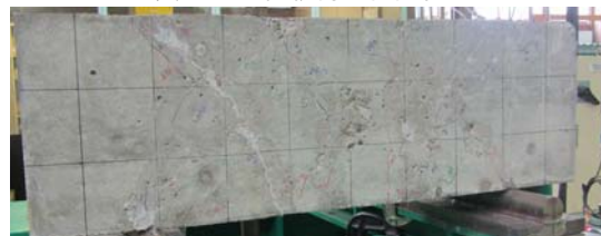
写真-2 注入後供試体状況
