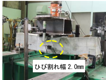
写真-5 CASE1 梁の状態
