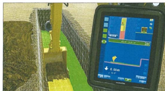
図 - 1 バックホウ・マシンガイダンス機構図
