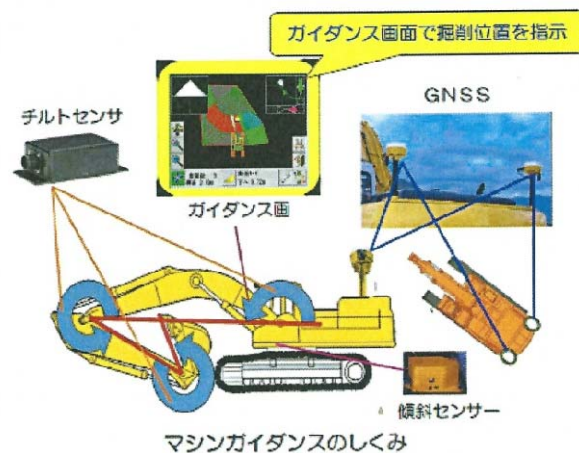
図 - 1 バックホウ・マシンガイダンス機構図
