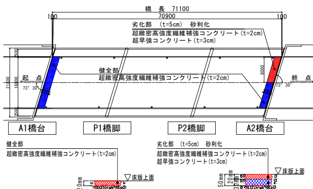
図-8 補修範囲平面及び、断面図
