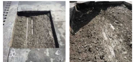
写真-1 微破壊試験状況(砂利化)
